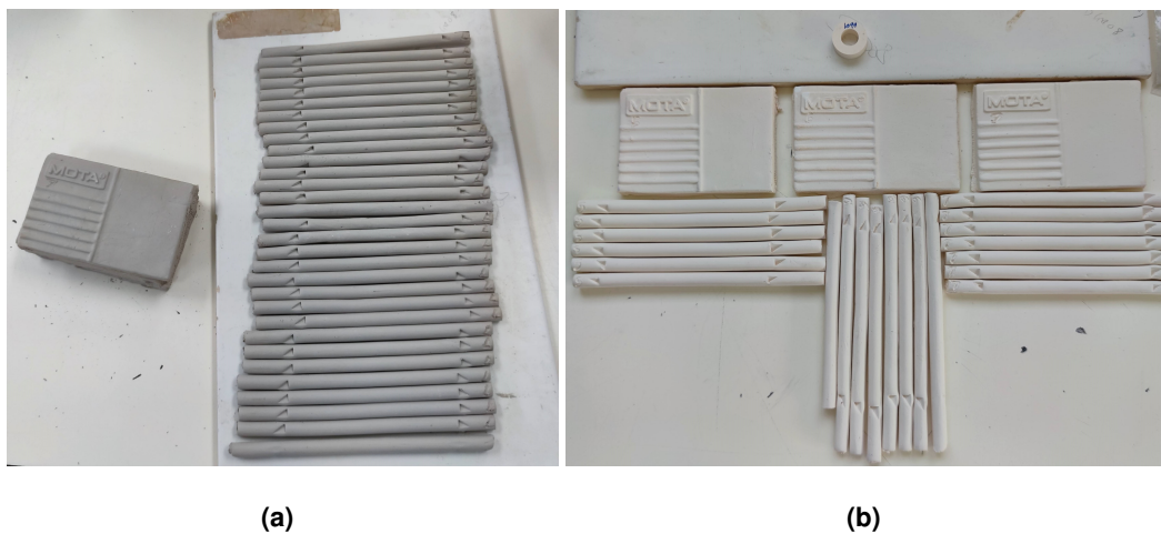
Figura 3.3: Provetes extrudidos e placas prensadas: a) Secos; b) Cozidos a 1100°C.
