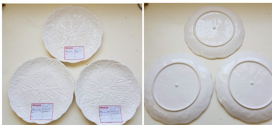
Figura 4.39: Produto final cozido e vidrado. a) Vista superior; b) Vista inferior.
