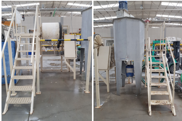
Figura 3.5: Moinho e turbo-diluidor utilizados na planta piloto.
