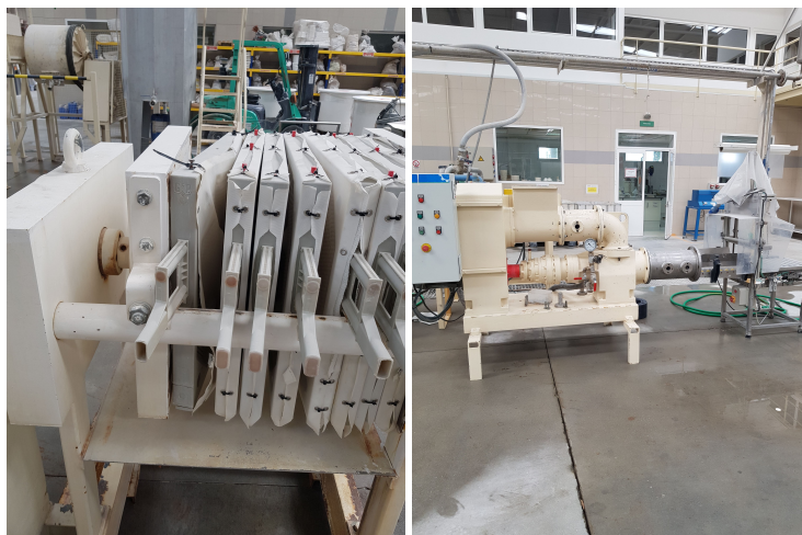
Figura 3.6: Filtro-prensa e extrusora utilizados na planta piloto.
